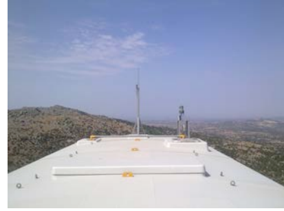
Şekil 9: Rüzgar türbini Jeneratör bölgesi Yıldırımdan Korunması[6]
